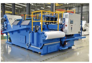
威泽最先进的全自动真空过滤系统可为单机床或多机床提供大到 9000L/min,过滤精度 达到 10um 的切屑液处理。
