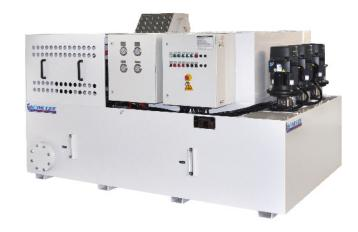
威泽最新型的 WOFNA 系列刀具 磨床过滤系统,可为单机或多机提供过 滤,过滤精度最高可达 1 微米 (1um)。
